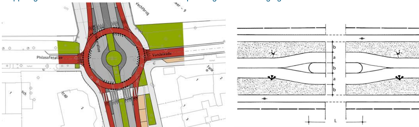
Figuur 1 Schematische weergave van oplossing met een fietsrotonde en een oplossing met uitbuiging (rechts).
